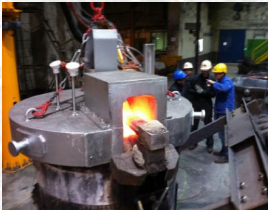
Préchauffage d'une poche de fonderie de 6t
